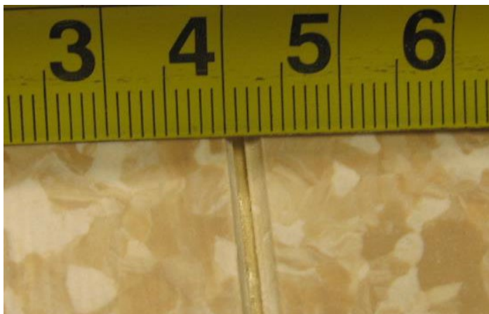
Zdjęcie prawidłowo wyfrezowanej szzeliny
